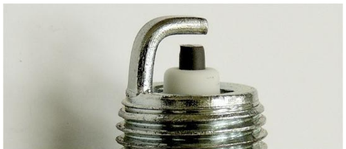
Vzhled zapalovací svíčky při použití předepsaného utahovacího momentu
