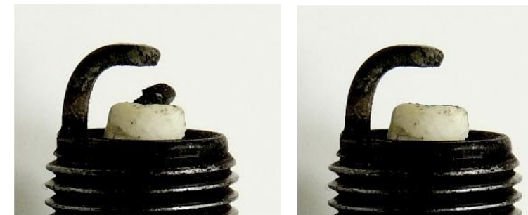
Vzhled zapalovací svíčky při překročení předepsaného utahovacího momentu
