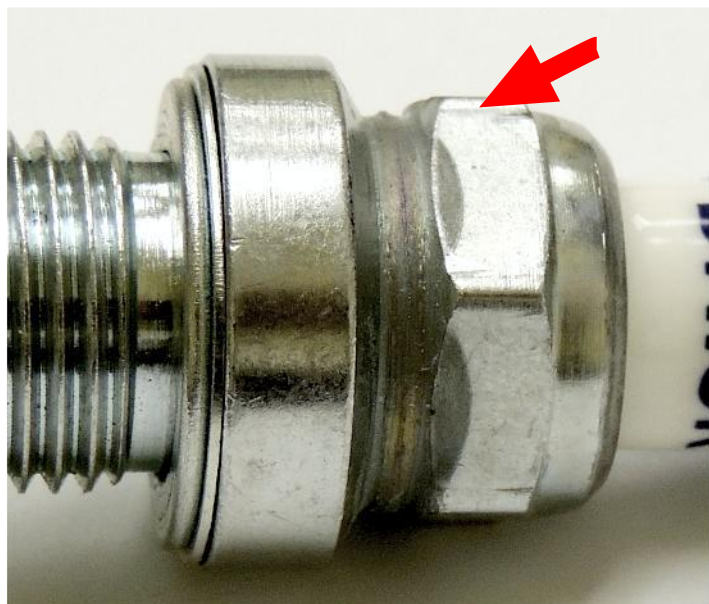
Vzhled zapalovací svíčky při použití předepsaného utahovacího momentu
